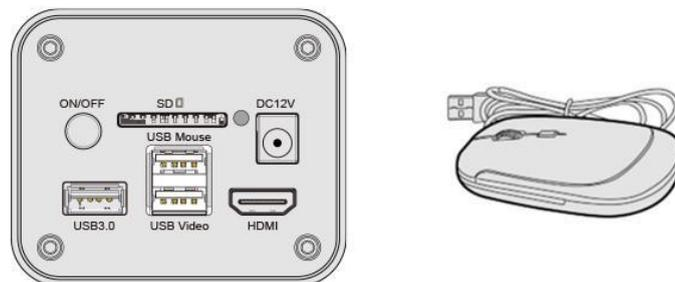
SD カード/USB フラッシュドライブをカメラの SD カード スロット/USB3.0 スロットに挿入します。
