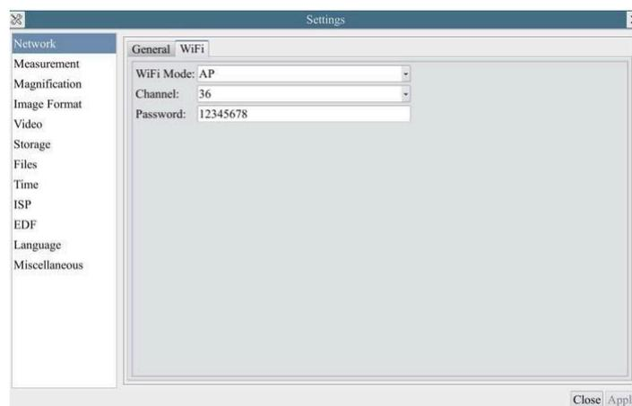
USB WiFi アダプターをカメラの USB3.0 ポートに接続すると、HDMI グラフィック インターフェイスの左上隅に「[APモード](#)」表示されます。
