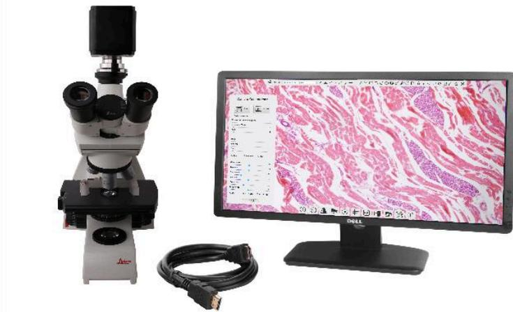
図 5 HDMI モニターを備えたカメラ
