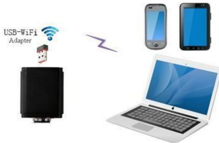
図 8 PC またはモバイル デバイスが WiFi 経由でカメラに接続する
